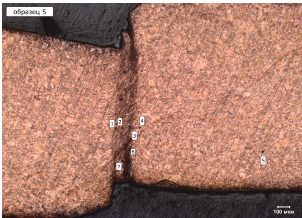
Рисунок 4.5 - Макрошлиф образца из медного сплава М1 в 100 кратном увеличении подвергнутого обратному деформированию при \Delta_1=50 и \Delta_2=50\% с обозначением точек касания инструмента для измерения микротвердости.
