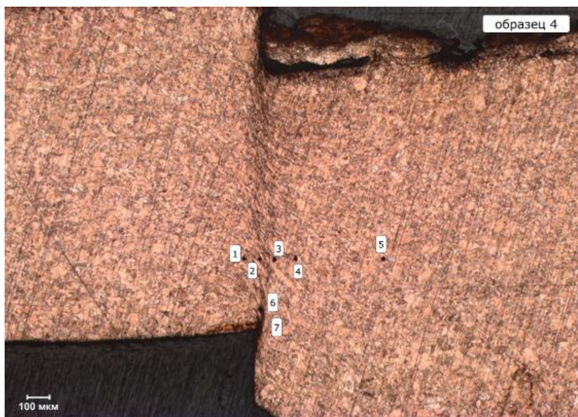
Рисунок 4.4 - Макрошлиф образца из медного сплава М1 в 100 кратном увеличении подвергнутого прямому деформированию при \Delta_1=50\% с обозначением точек касания инструмента для измерения микротвердости.
