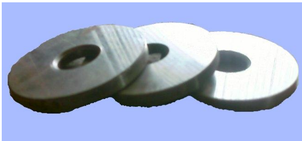
Рисунок 2.3 – Ограничительные шайбы (позиция 9 на схеме)
