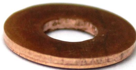
Рисунок 4.9 –Внешний вид шайбы после обратной вырубki. Увеличение 7х.
