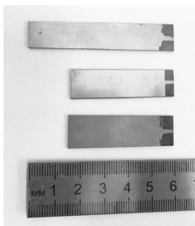
Рисунок 10 – Элементы деформации на основе монокристаллических бидоменных структур
