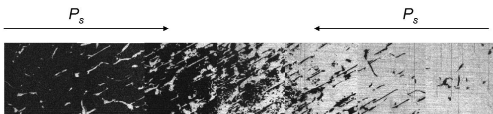
Рисунок 9 – Латеральная составляющая компоненты пьезоотклика.
