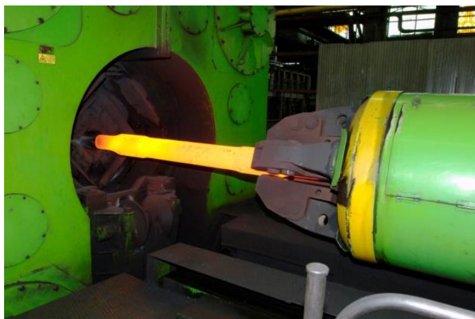
Рисунок 7 - Ковка вагонной оси на РКМ RF-35
