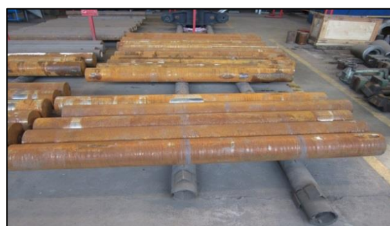
Рисунок 35 – Исходные заготовки в состоянии поставки в цех АО ВМЗ.
