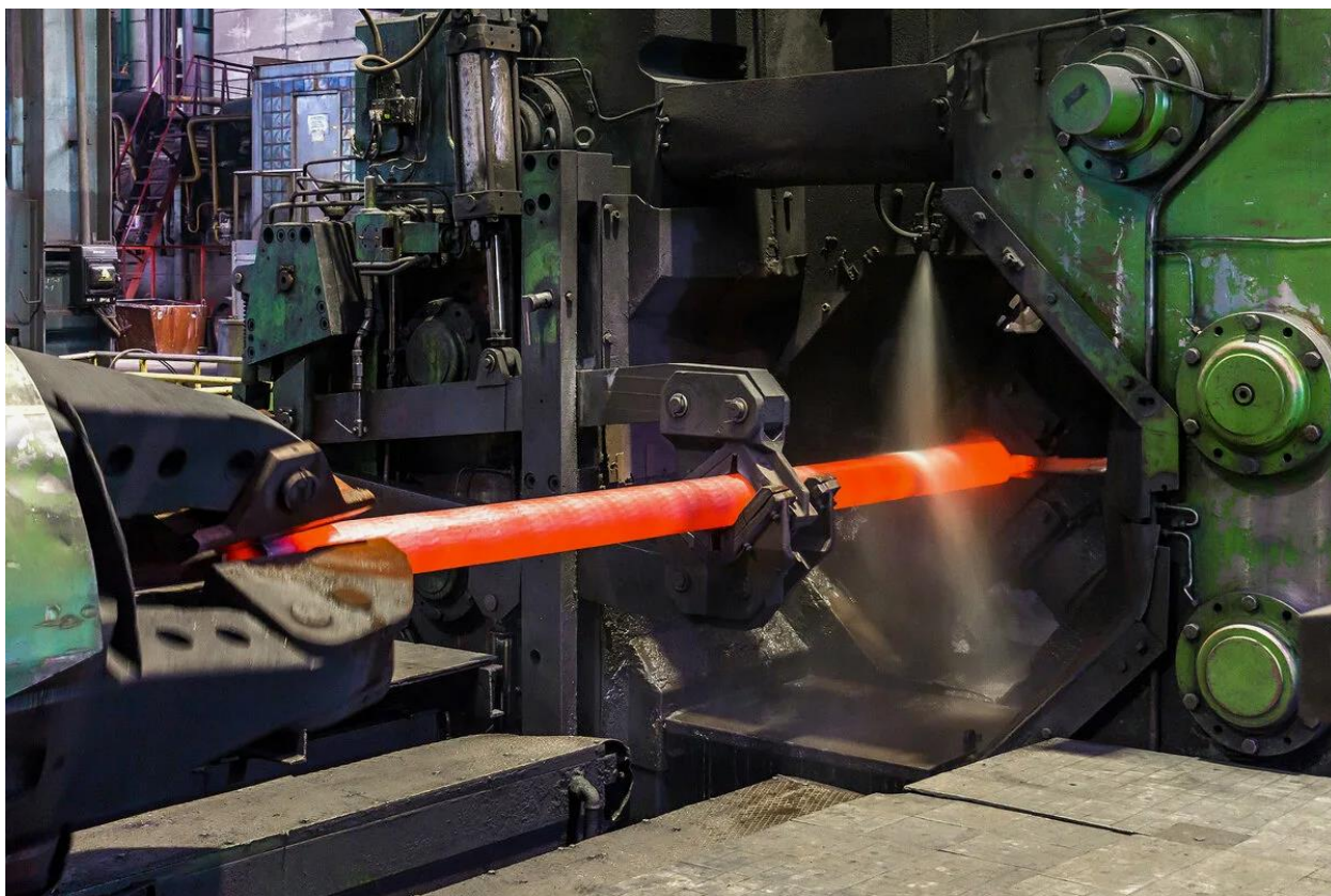
Рисунок 6 - Ковка вагонной оси на РКМ SXP-55
