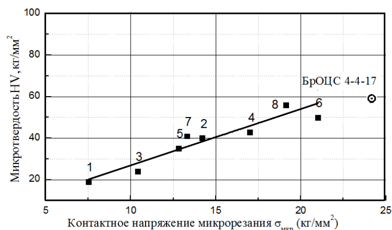
Рисунок 5.4 - Корреляция между микротвёрдостью и контактным напряжением микрорезания (№1.1-1.8 - номера исследуемых образцов)
