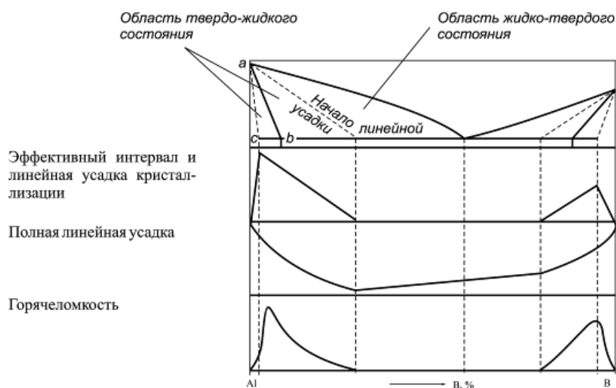
Рисунок 1.21 - Схемы зависимости литейных свойств от состава сплавов в системе эвтектического типа [99] (об - равновесный солидус; ас - неравновесный солидус):
