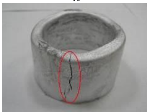
Рисунок 6.6 -Кольцевые отливки из экспериментальных сплавов на основе системы АОЗ-7
