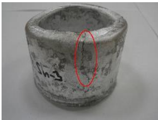
Рисунок 6.7 - Кольцевые отливки из экспериментальных сплавов на основе системы Al-6%Sn
