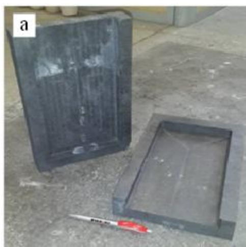
Рисунок 2.2 – Внешний вид графитовой изложницы (а) и чертеж слитка (б), полученного литьем в эту форму.
