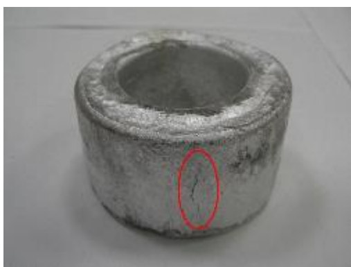
Рисунок 6.6 -Кольцевые отливки из экспериментальных сплавов на основе системы АОЗ-7
