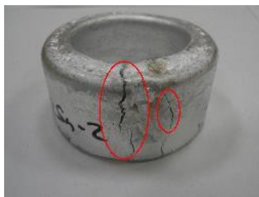
Рисунок 6.6 -Кольцевые отливки из экспериментальных сплавов на основе системы АОЗ-7
