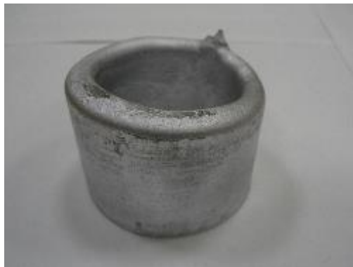
Рисунок 6.4 - Кольцевые отливки из экспериментальных сплавов на основе системы АК5Мч
