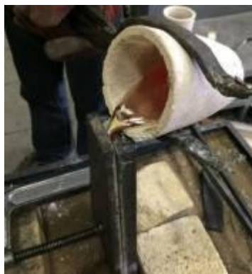
Рисунок 5.19 – Заливка пробы на горячеломкость «Арфа»
