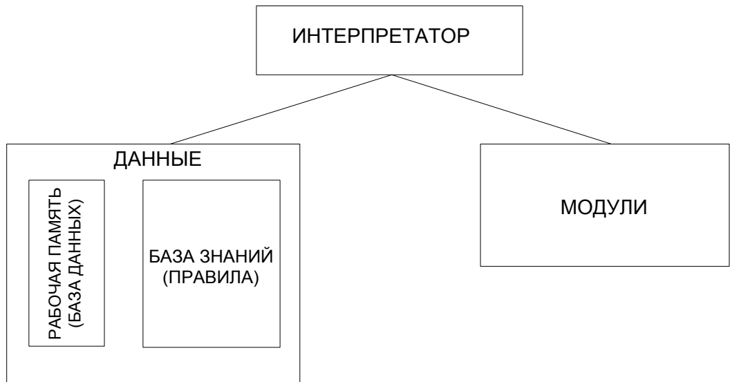
Рис. 3.6 - Схема функционирования управляющей компоненты ЭС
