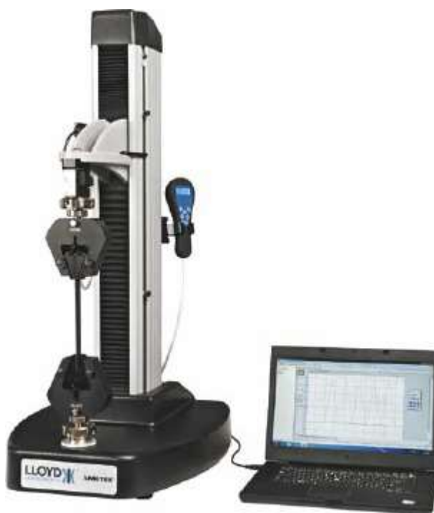
Рисунок 49 – Установка для определения прочностных свойств одиночных волокон и нитей (LS1)
