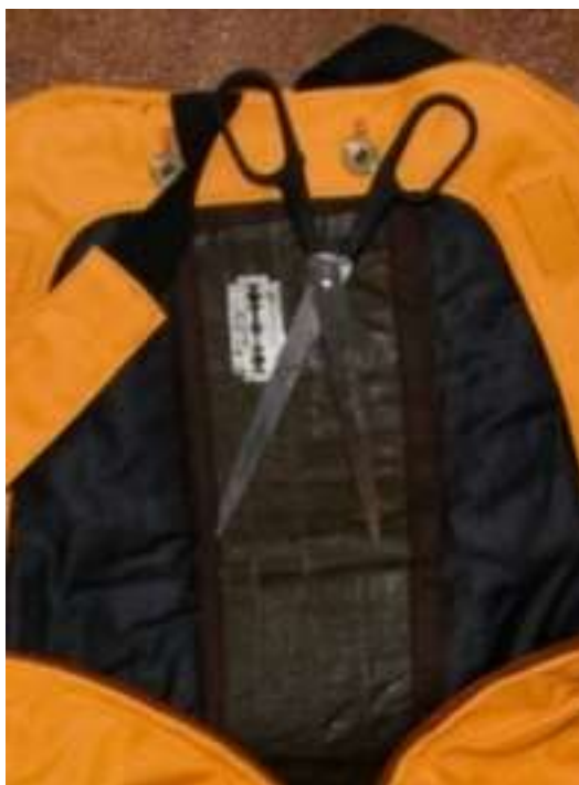
Рисунок 45 – Фрагмент магнитной вставки, изготовленной из опытного образца магнитных волокнистых наноматериалов
