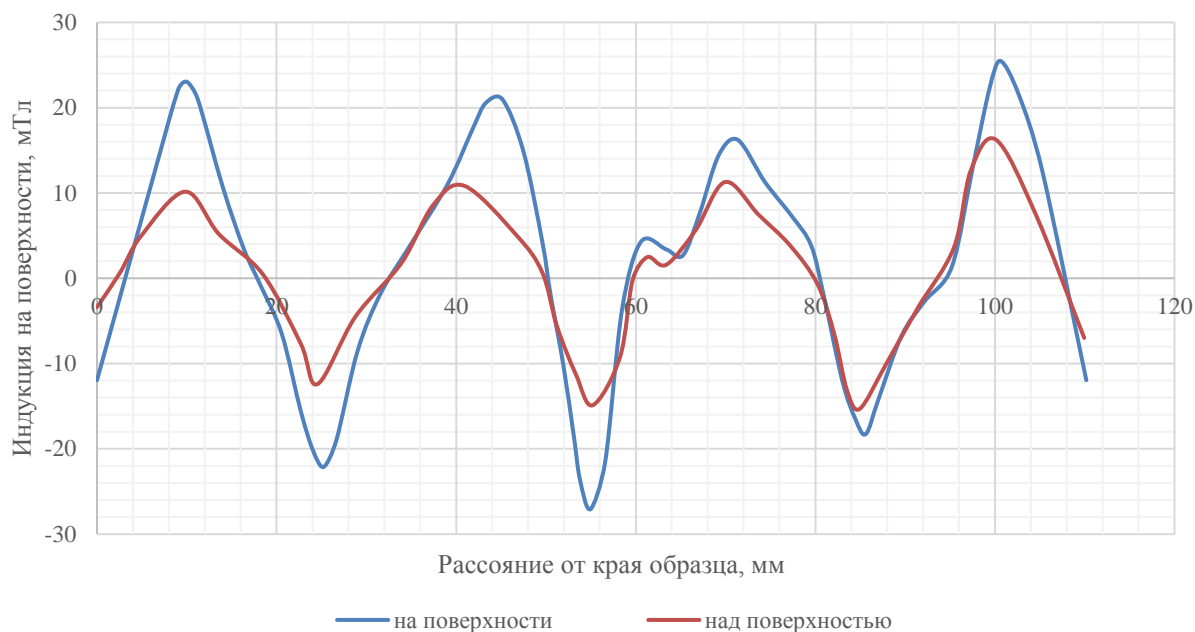
Рисунок 42 – Измерение магнитной индукции поля над тканью вдоль образца
