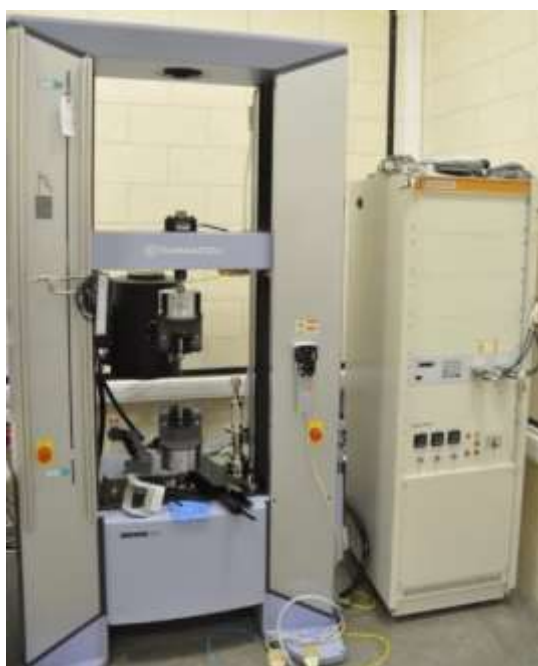
Рисунок 46 – Универсальная испытательная машина AG-20kNX (определение динамического модуля)
