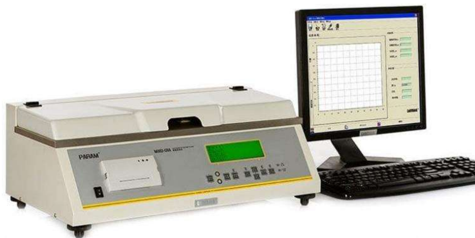
Рисунок 50 – Установка для определения фрикционных свойств опытных образцов волокнистых магнитных материалов (ASTM D1894, MXD-01A)
