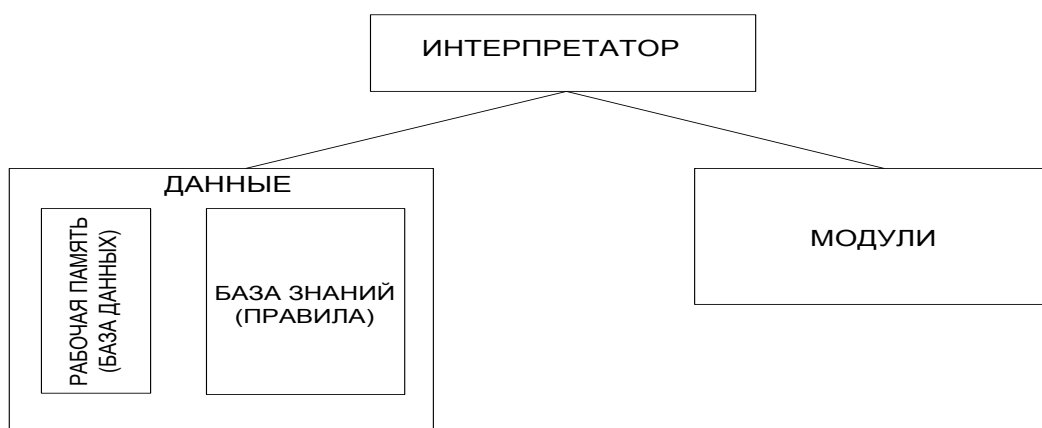
Рисунок 8 - Схема функционирования управляющей компоненты ЭС
