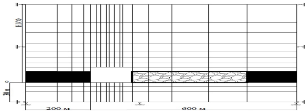
Рисунок 13 - Расчетная схема МКЭ для определения нагрузок на крепь в центре разворота
